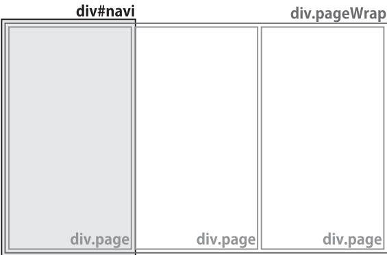
그림 6 패널의 배치도. 가장 왼쪽 윤곽의 div#navi 부분이 실제로 표시되는 영역이 된다.
